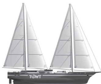
Figure 5 : Voilier-cargo de la Classe Phénix avec une longueur hors tout de 81 mètres et deux grues intégrées pour transporter 1090 tonnes
