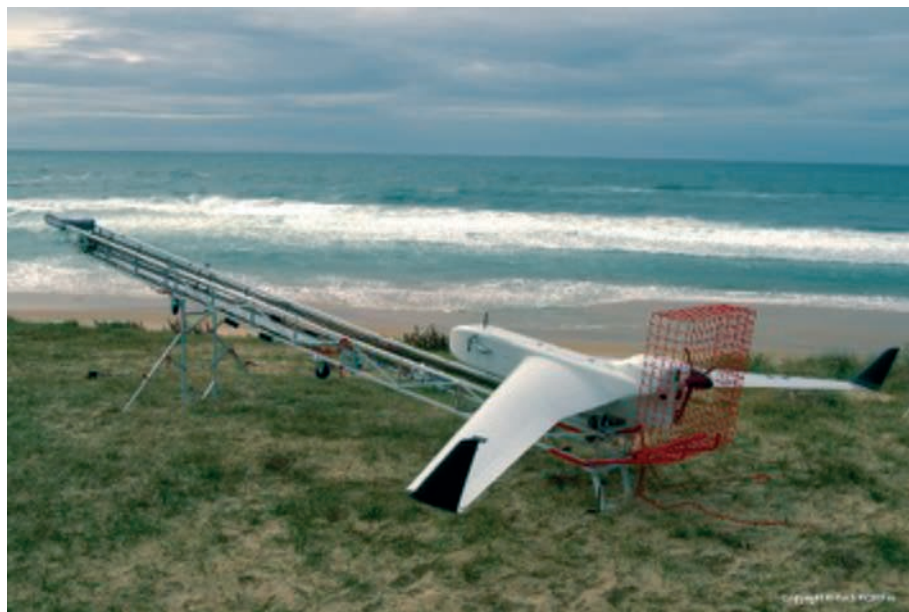
Figure 4. Exemple de drone de surveillance, autonomie de 8h et plusieurs centaines de km
